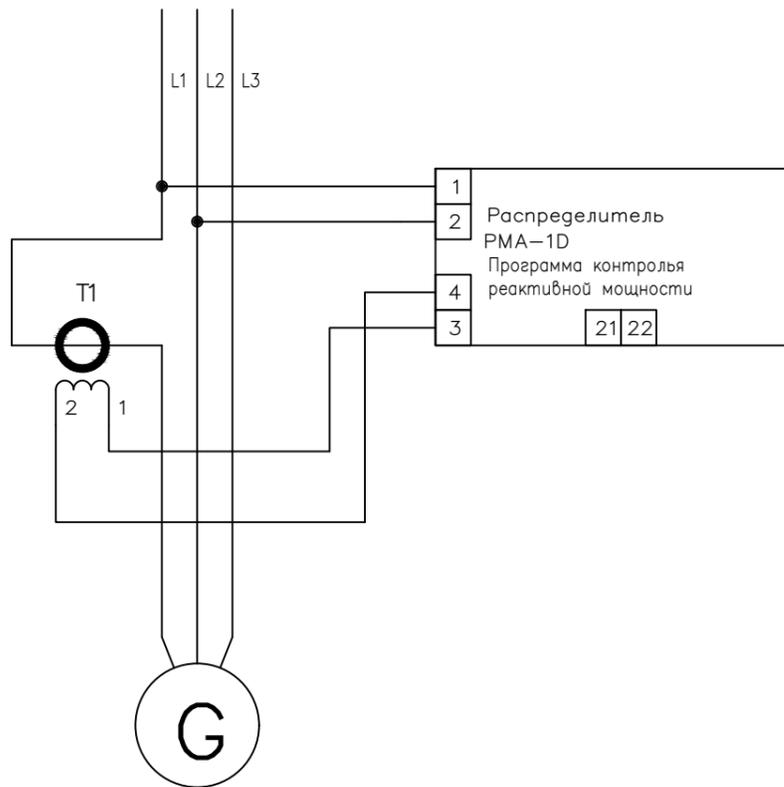
1. При правильном подключении РМА (две станции работают в параллель, нагрузка отсутствует):
